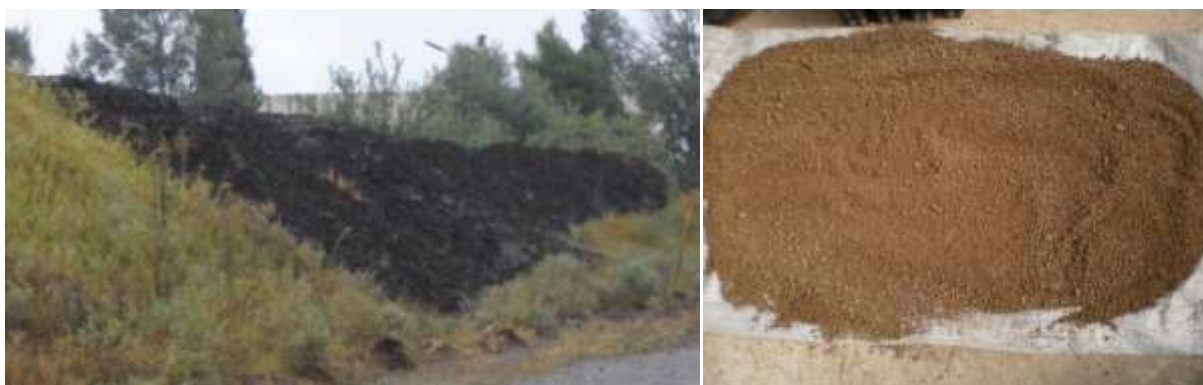
Πλούσιο σε οξείδια του Fe και Mn υλικό, παραπροϊόν της επεξεργασίας πυρολουσίτη (Tosoh-Hellas)
