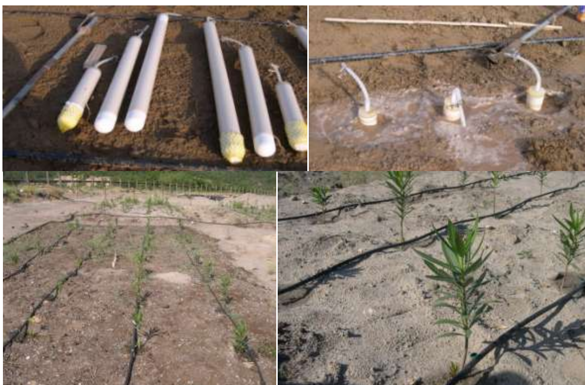
Τοποθέτηση λυσιμέτρων για τη λήψη του εδαφικού διαλύματος (Φεβρουάριος, 2011)
