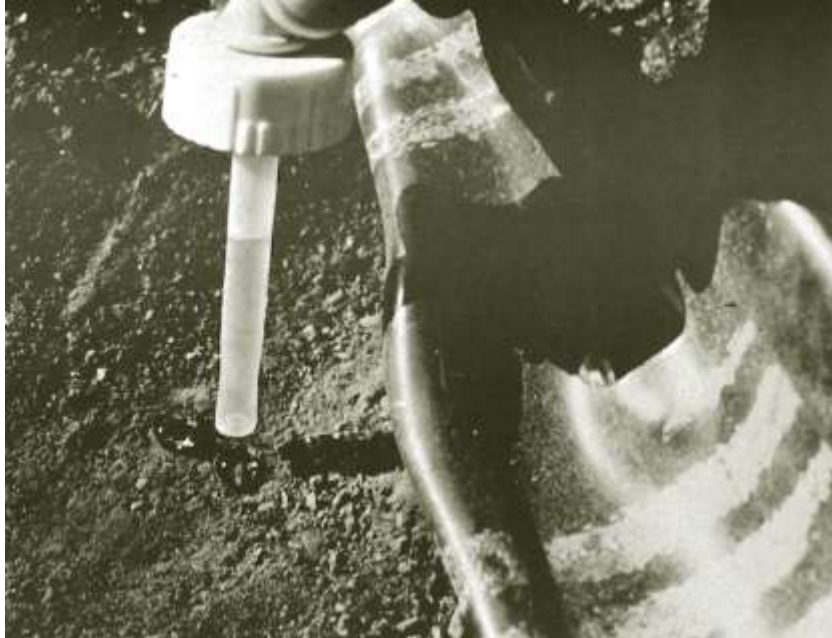
Εικόνα 1-1. Δοκιμή υδροφοβίας εδάφους (από DeBano 1981)
